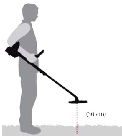
Ilustracja 17 – Prawidłowa pozycja wykrywacza w przypadku eliminacji zakłóceń
